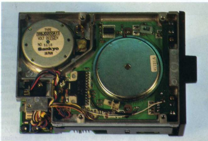
Visione interna della parte superiore del floppy disk drive prodotti dalla Micro Peripherals. Da notare il motorino di trascinamento del disco.
