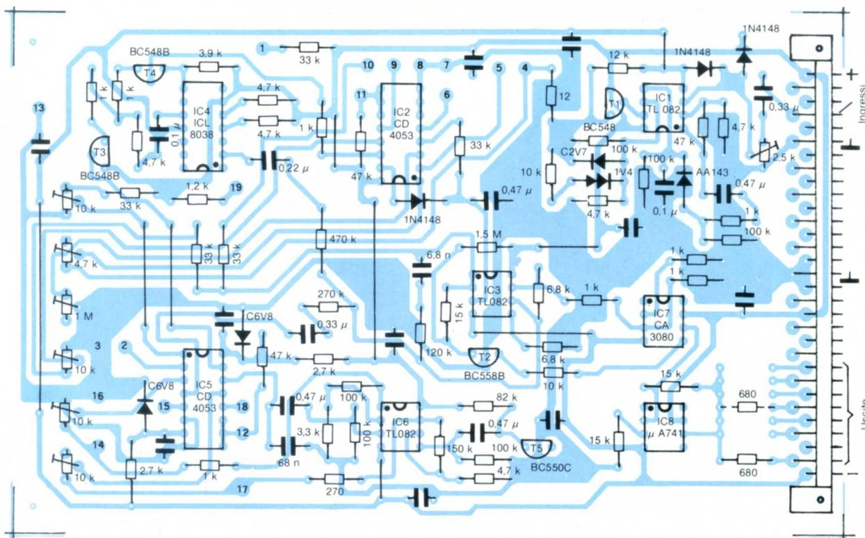
Fig. 9. Disposizione dei componenti per il sintetizzatore di strumenti a percussione. Tutti i condensatori di cui non è stato dato il valore, devono essere componenti ceramici da 47 nF.
