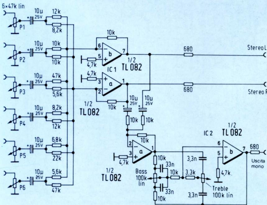
Fig. 5. Schema del canale sommatore, con il quale è possibile prestabilire la posizione degli strumenti nell'ambito della base stereo; oltre all'uscita stereo è prevista un'uscita per monitor (monaurale) con regolazione del tono.
