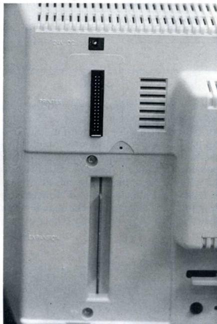
Vista posteriore del monitor. In evidenza l'alloggiamento per l'interfaccia RS232/Centronics.
