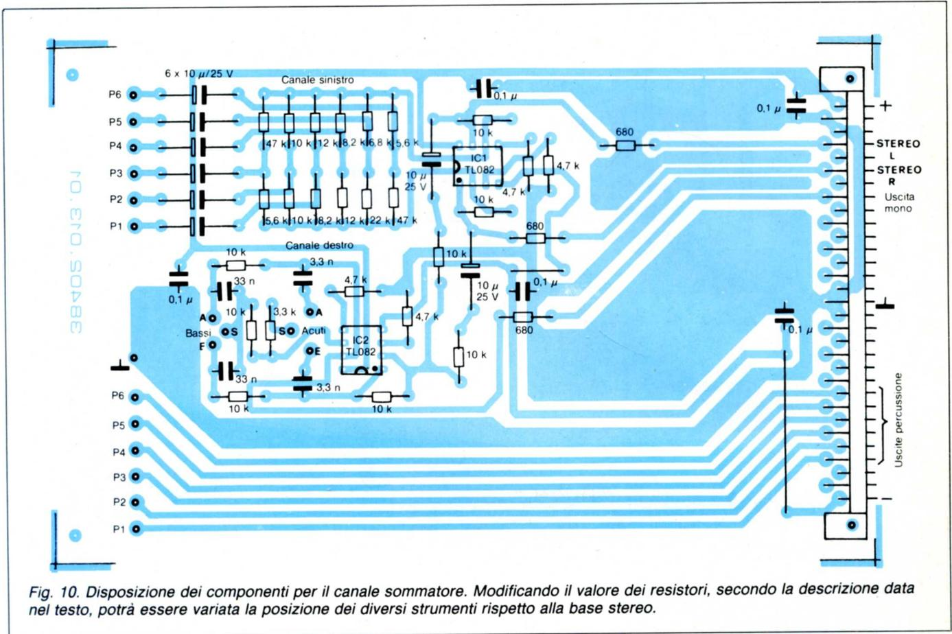
Fig. 10. Disposizione dei componenti per il canale sommatore. Modificando il valore dei resistori, secondo la descrizione data nel testo, potrà essere variata la posizione dei diversi strumenti rispetto alla base stereo.
