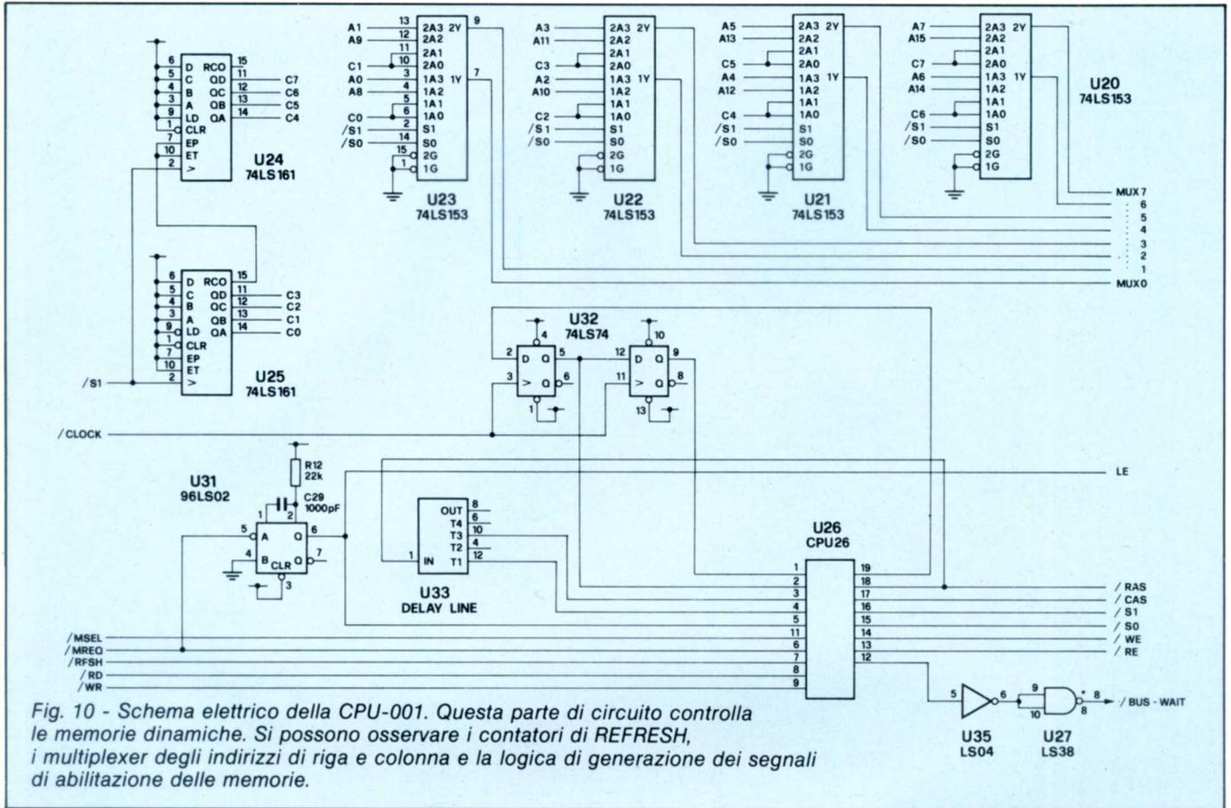
Fig. 10 - Schema elettrico della CPU-001. Questa parte di circuito controlla le memorie dinamiche. Si possono osservare i contatori di REFRESH, i multiplexer degli indirizzi di riga e colonna e la logica di generazione dei segnali di abilitazione delle memorie.
