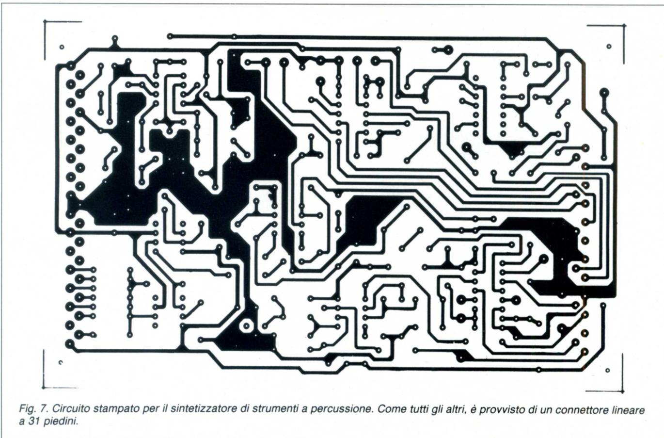
Fig. 7. Circuito stampato per il sintetizzatore di strumenti a percussione. Come tutti gli altri, è provvisto di un connettore lineare a 31 piedini.
