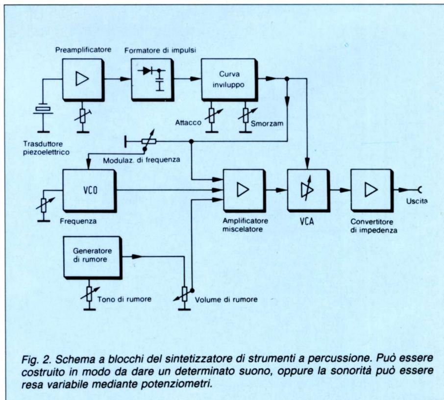
Fig. 2. Schema a blocchi del sintetizzatore di strumenti a percussione. Può essere costruito in modo da dare un determinato suono, oppure la sonorità può essere resa variabile mediante potenziometri.
