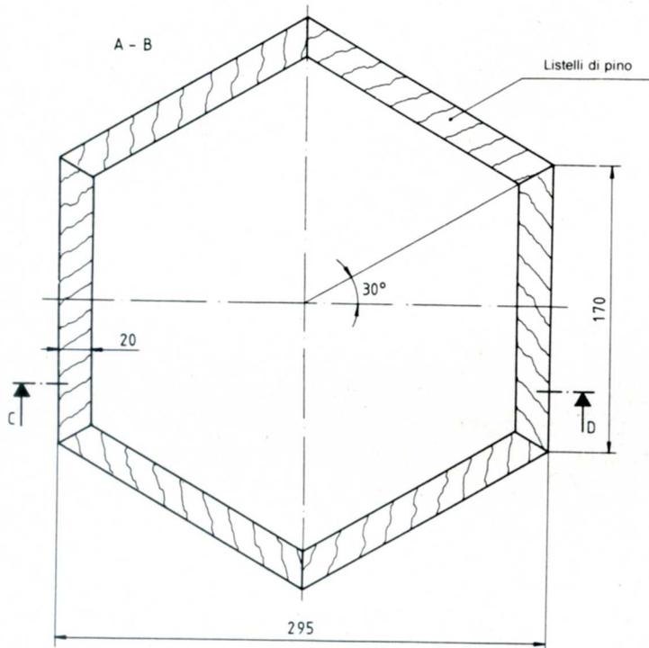
Fig. 17. Schizzo costruttivo quotato di una pad. Quest'ultima dovrà essere costruita utilizzando legno più duro possibile, e non dovrà produrre fruscio (od almeno ne dovrà produrre molto poco) quando viene utilizzata. Come trasduttore acustico viene impiegato un cristallo piezoelettrico (oppure una capsula microfonica a cristallo) fissato al centro della superficie di percussione mediante nastro biadesivo.
