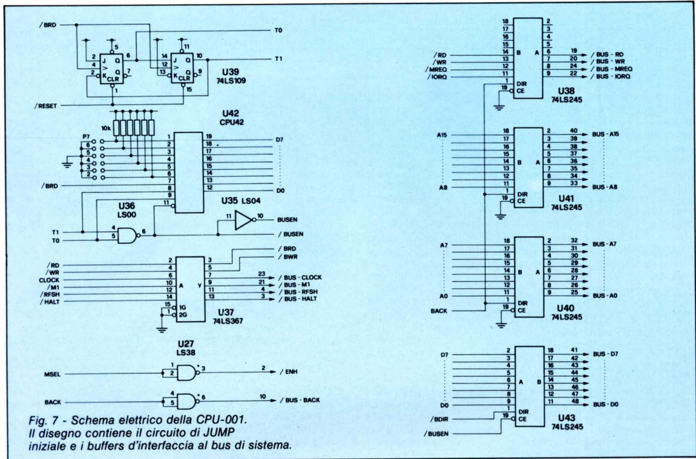
Fig. 7 - Schema elettrico della CPU-001. Il disegno contiene il circuito di JUMP iniziale e i buffers d'interfaccia al bus di sistema.
