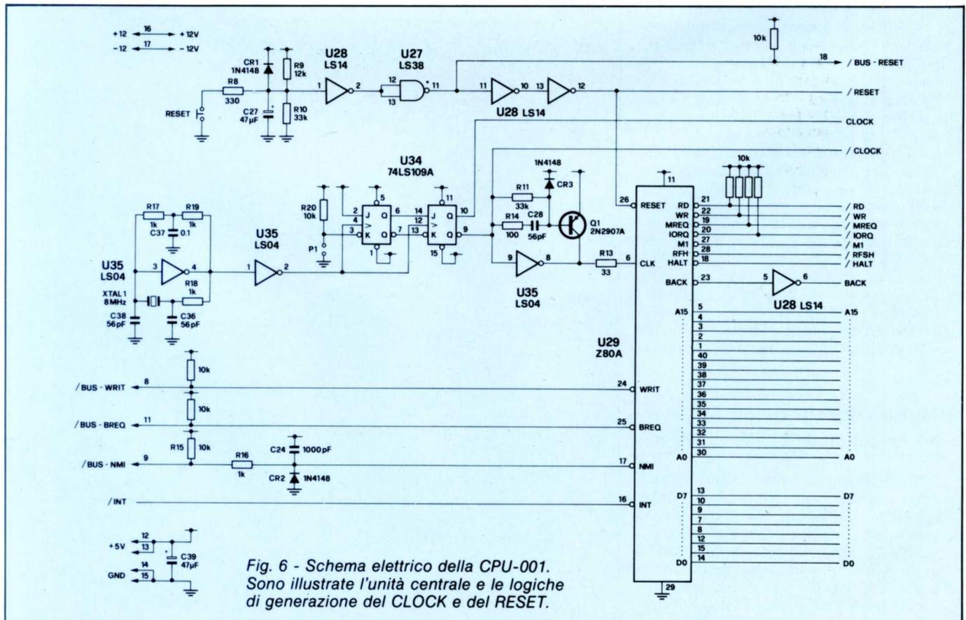
Fig. 6 - Schema elettrico della CPU-001. Sono illustrate l'unità centrale e le logiche di generazione del CLOCK e del RESET.
