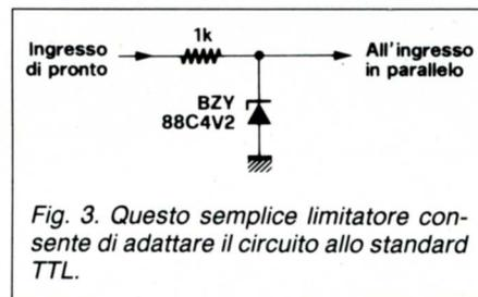
Fig. 3. Questo semplice limitatore consente di adattare il circuito allo standard TTL.
