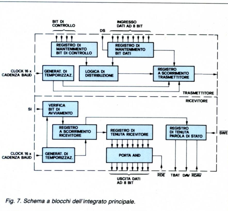
Fig. 7. Schema a blocchi dell'integrato principale.
