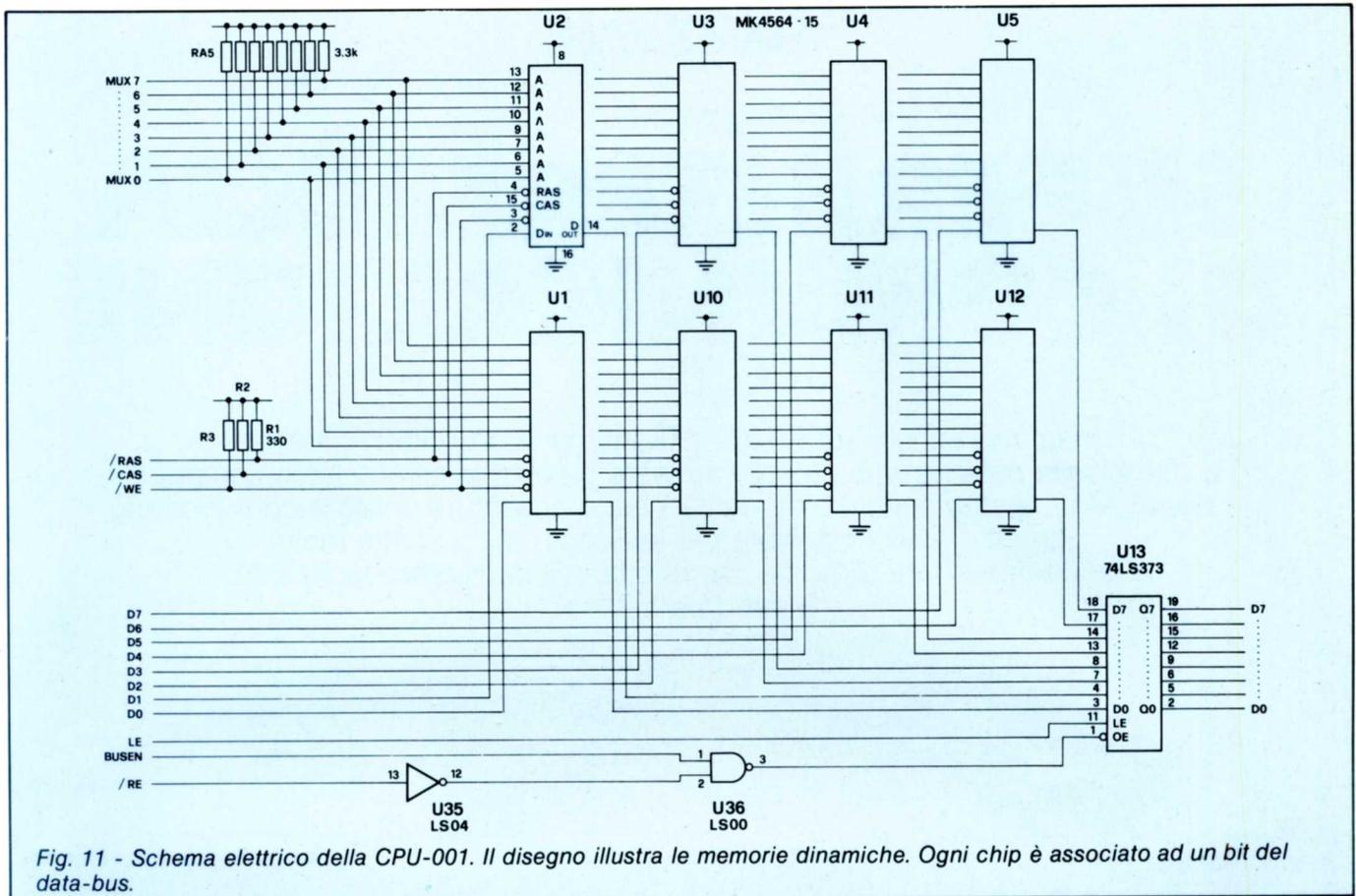
Fig. 11 - Schema elettrico della CPU-001. Il disegno illustra le memorie dinamiche. Ogni chip è associato ad un bit del data-bus.
