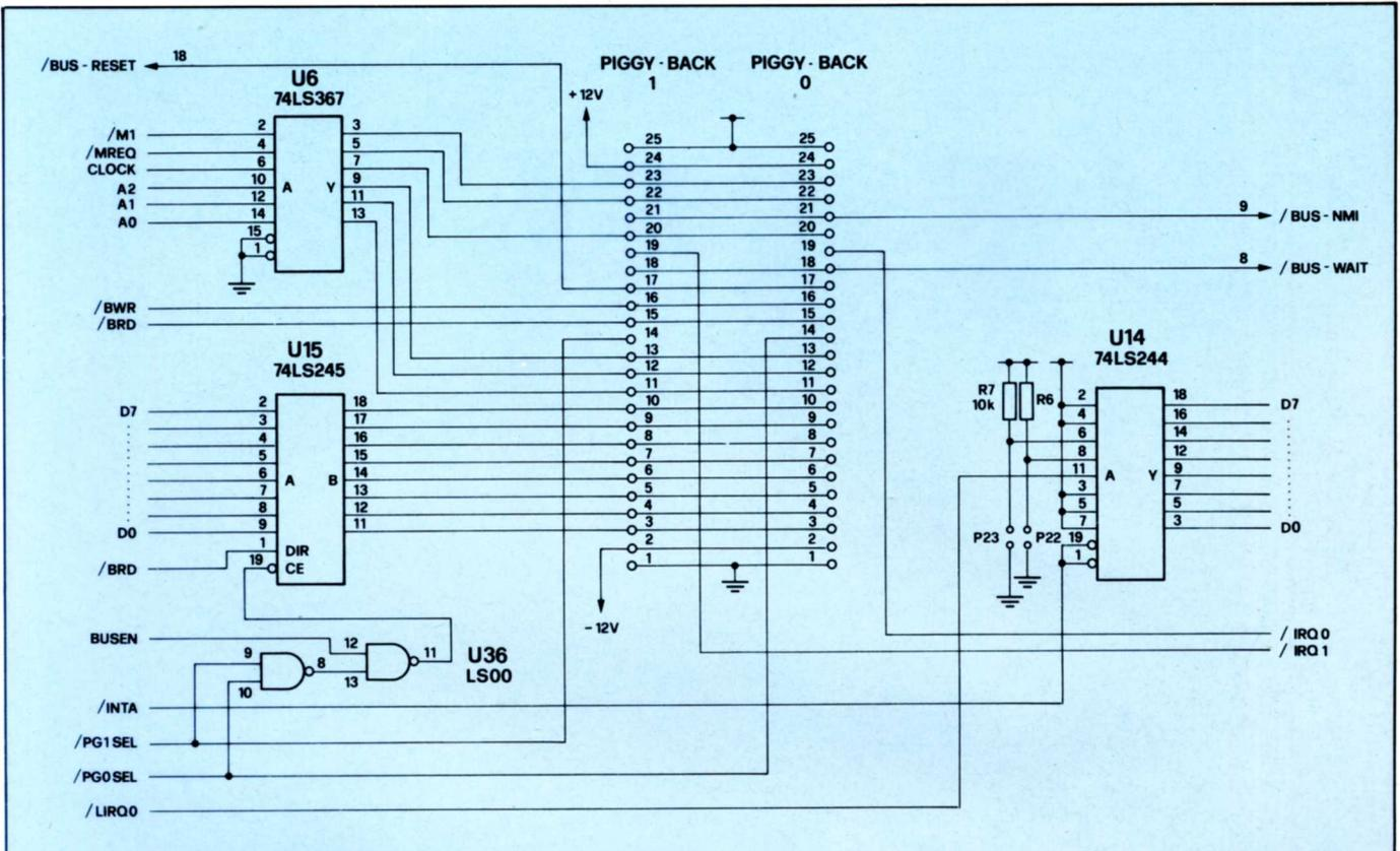
Fig. 9 - Schema elettrico della CPU-001. Rappresenta l'interfaccia ai piggy-back. Il 74LS244 serve per generare i vettori di RESTART delle interrupts.
