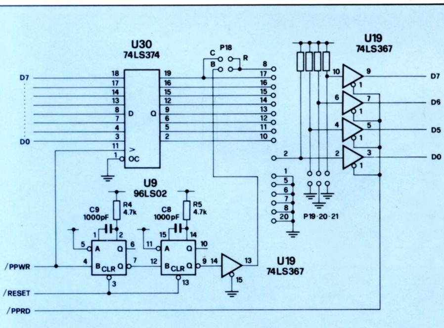
Fig. 8 - Schema elettrico della CPU-001. Si notino il circuito di abilitazione dei banchi di memoria, la logica di decodifica degli I/O, il controllo delle interrupts e l'interfaccia alla stampante.
