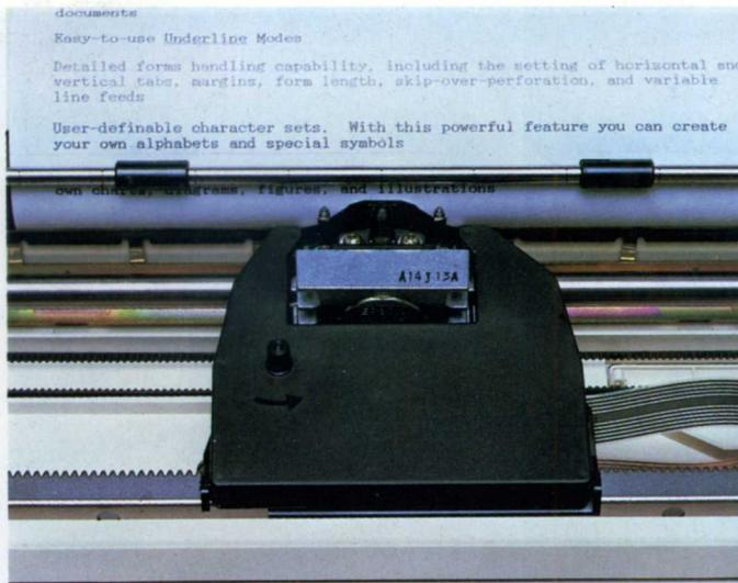
Particolare della testina della stampante Epson 2000. La stampa è in alta qualità come dimostra la foto e la velocità è di 272 caratteri al secondo.
