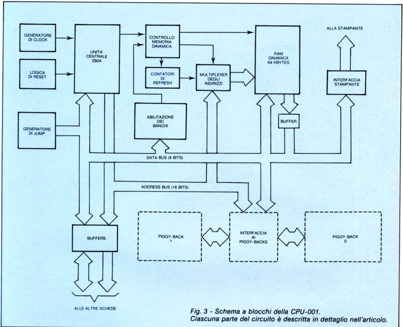
Fig. 3 - Schema a blocchi della CPU-001. Ciascuna parte del circuito è descritta in dettaglio nell'articolo.
