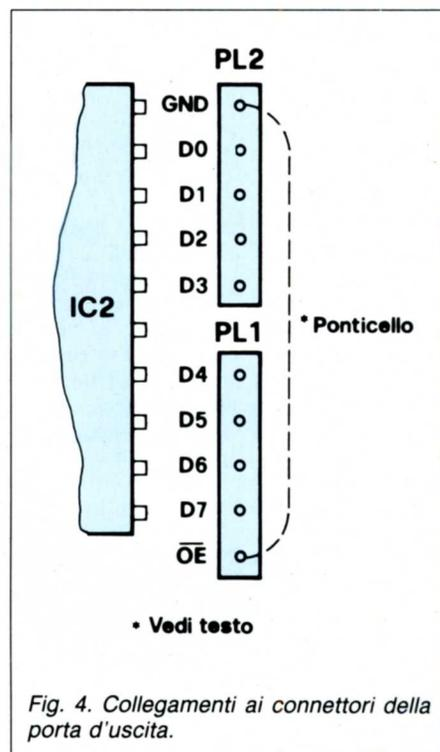
Fig. 4. Collegamenti ai connettori della porta d'uscita.
