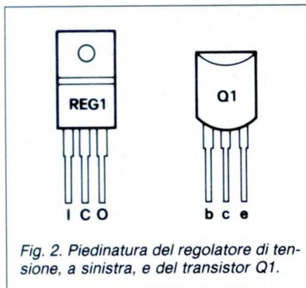
Fig. 2. Piedinatura del regolatore di tensione, a sinistra, e del transistor Q1.
