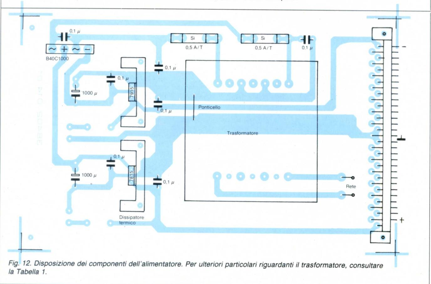
Fig. 12. Disposizione dei componenti dell'alimentatore. Per ulteriori particolari riguardanti il trasformatore, consultare la Tabella 1.
