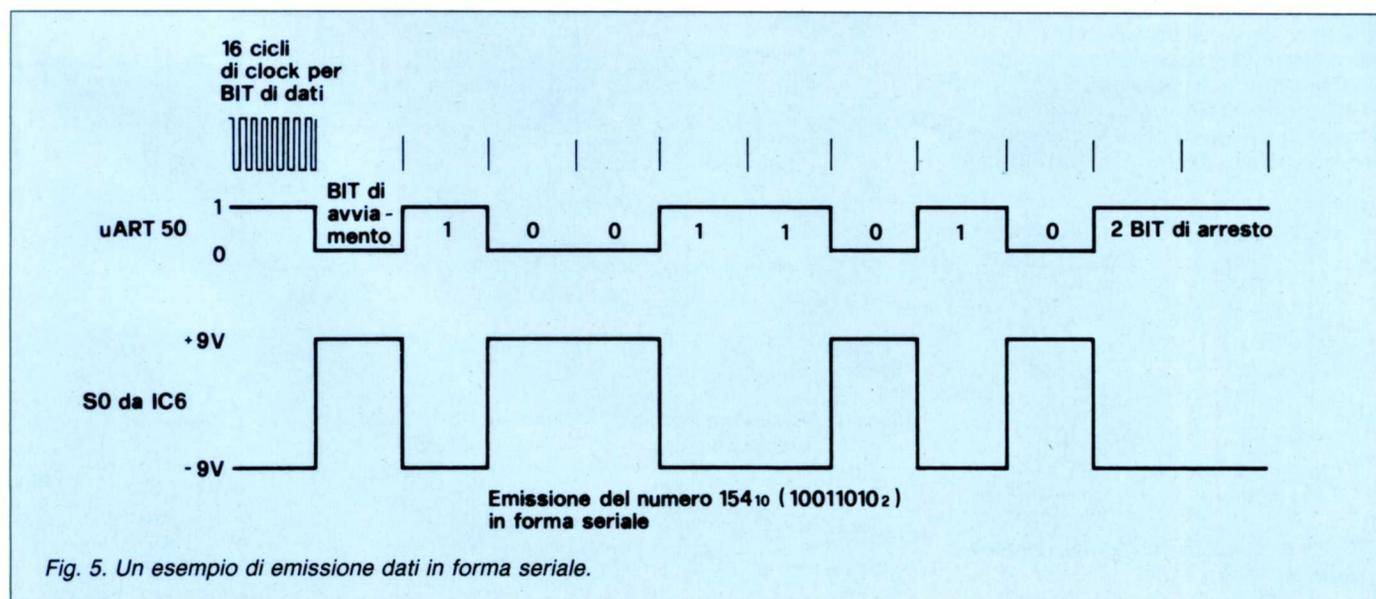
Fig. 5. Un esempio di emissione dati in forma seriale.
